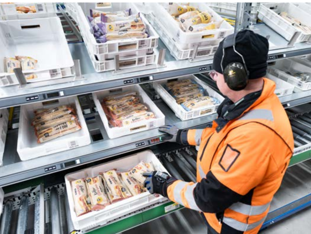
Das Pick-by-Light-System minimiert bei Kokkikartano Kommissionierfehler und erhöht gleichzeitig die Geschwindigkeit und Genauigkeit.
