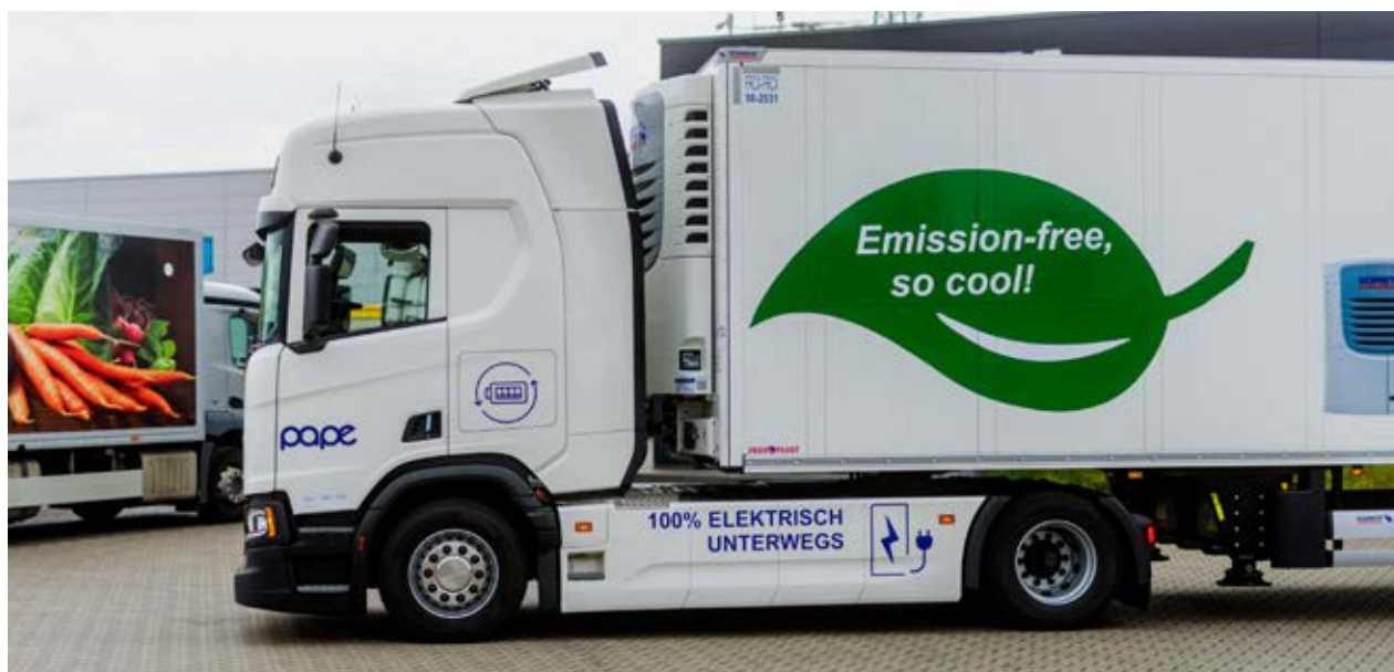
Die E-LKW von Scania erreichen bei Pape im Alltag eine Reichweite von rund 450 Kilometern.
