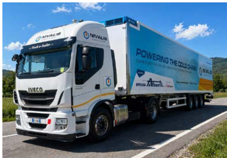
Beispiel für elektrifizierte Auflieger, die schon heute auf den Straßen unterwegs sind.
