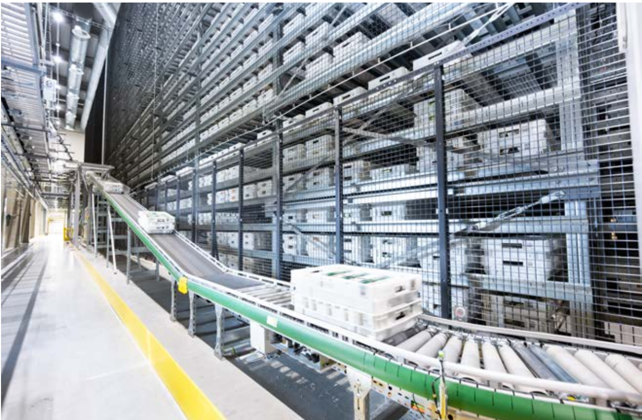
Fertige Produkte werden automatisch und ohne manuelle Prozesse ins Lager, zur Kommissionierung oder zum Versand transportiert.
