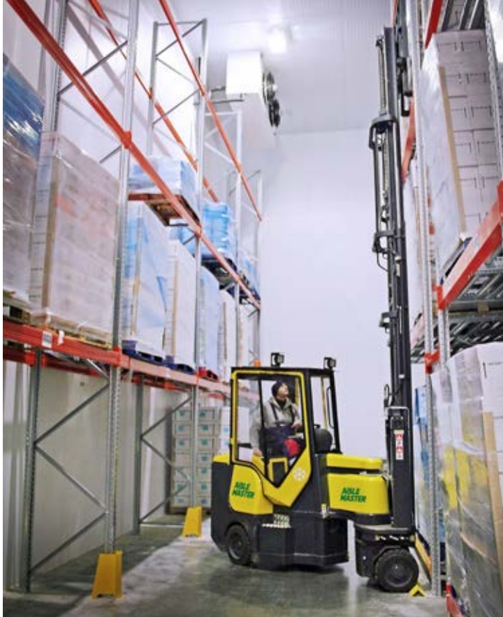
Combilifts Gelenkstapler »Aisle Master« ist in einer Kühlhaus-Konfiguration erhältlich und kann so helfen, die Lagerkapazität zu maximieren und das Kühlvolumen zu minimieren.
