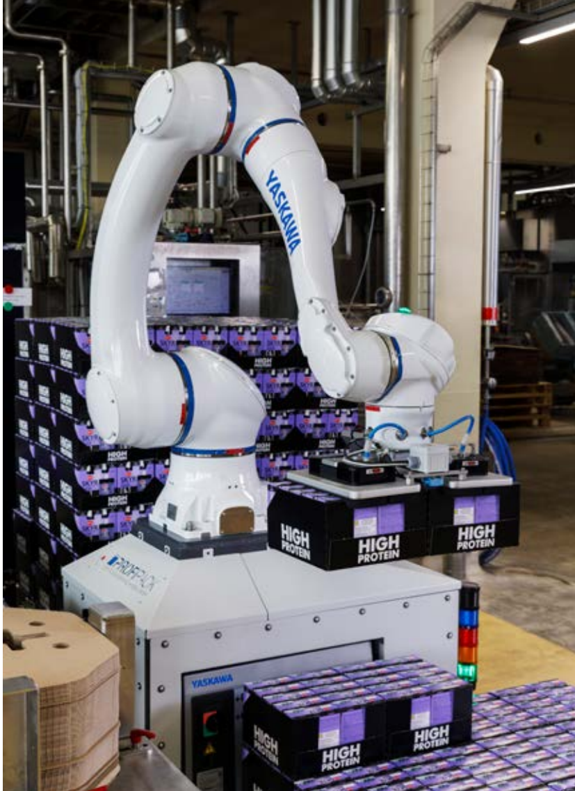
Der sechssachsige HC20DTP bietet 20 Kilogramm Tragkraft und 1900 Millimeter Arbeitsbereich. Schaltschrank und Steuerung sind platzsparend im Sockel integriert.
