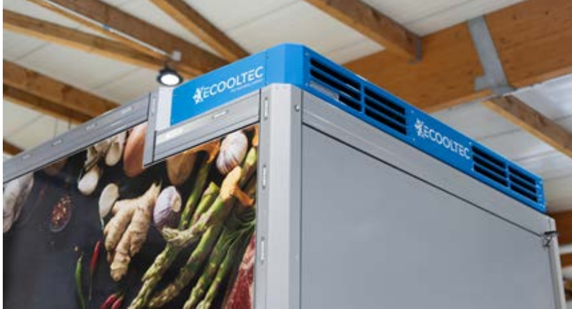
Die charakteristische Nische im Aufbau für Ecooltecs TM182 ist prinzipbedingt: Die Anlage hat zwei Kühlkreisläufe mit zwei verschiedenen Kältemitteln, der mit dem brennbaren Propen betriebene Primärkreislauf ist außerhalb des Kühlkoffers angeordnet.
