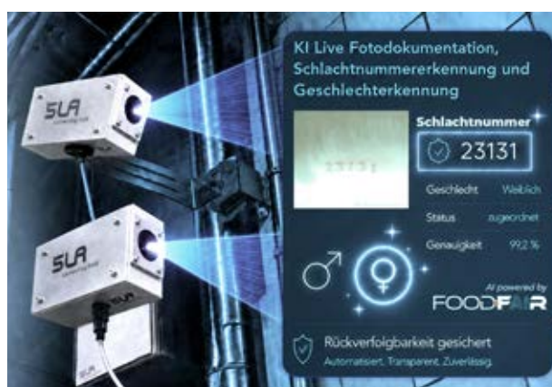
Für die KI-gestützte Geschlechtererkennung kommen zwei Industriekameras in Edelstahlgehäusen zum Einsatz.
