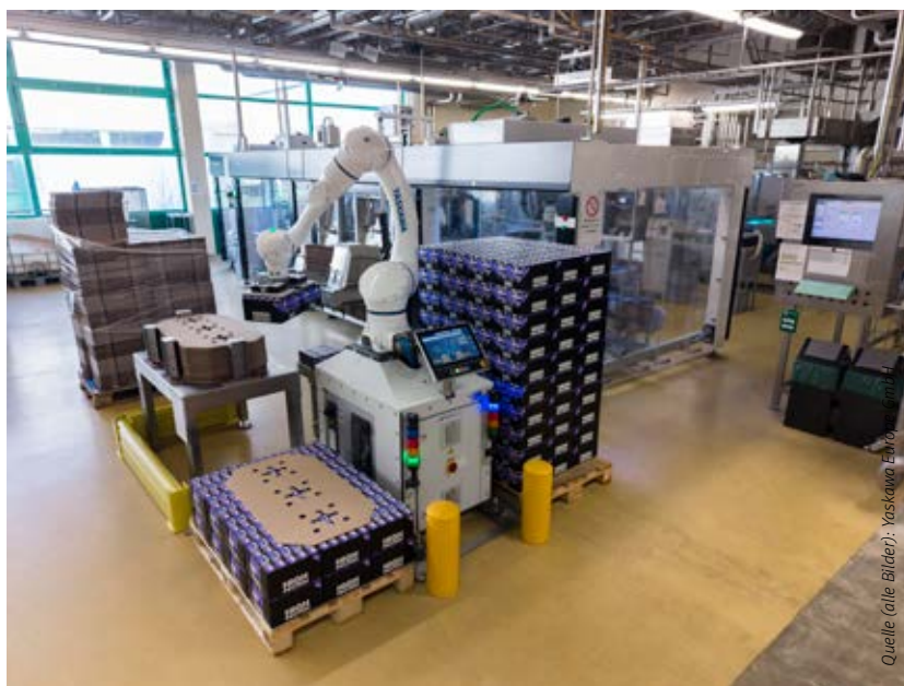
Der Cobot entnimmt die Trays aus dem vorgeschalteten Packer, setzt sie auf Paletten um und fügt selbstständig Karton-Zwischenlagen ein.
