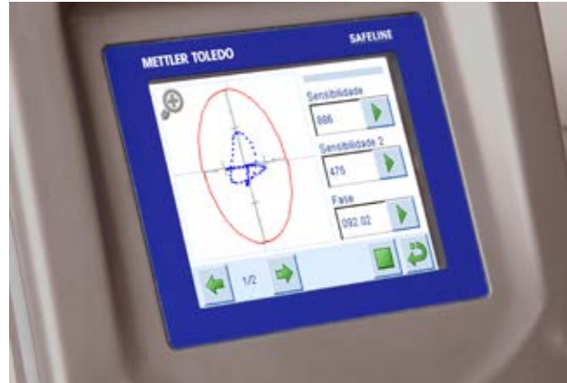
Funktionen für automatische Feuchteüberwachung, Mehrfachfrequenz-Technologie mit Hochfrequenzbetrieb und adaptive Signalverarbeitung können Hersteller dabei unterstützen, eine hohe Erkennungsempfindlichkeit unter unterschiedlichsten Bedingungen aufrechtzuerhalten.
