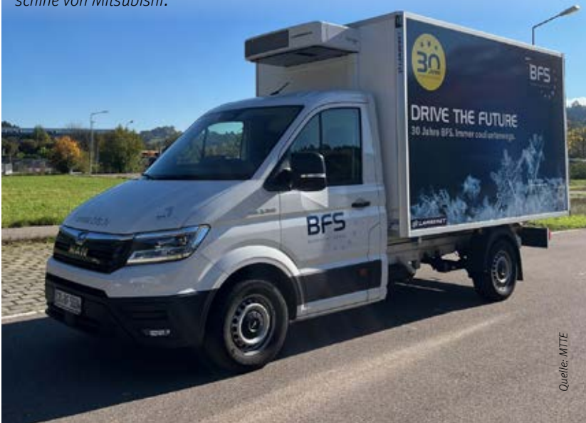
Ein TGE-Transporter aus der Flotte von BFS mit TEK Kühlmachine von Mitsubishi.
