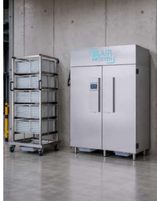
Der Airfroster temperiert Kühlakkus auf definierte Zieltemperaturen.
