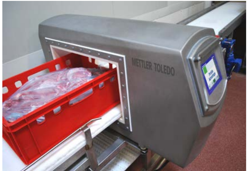
Wenn gefrorene Produkte auf ihrem Weg entlang der Produktionslinie antauen, kann sich ihr Verhalten in den Magnetfeldern von Metallsuchsystemen ändern.
