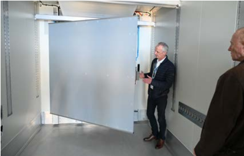
Frank Nordhoff demonstriert die schwenkbare Thermoplast-Prallwand, die Krone im Inneren des Cool Liner als Option statt eines Alu-Profils bietet. Das unterstützte den Service und bietet einen Gewichtsvorteil von 25 Prozent.
