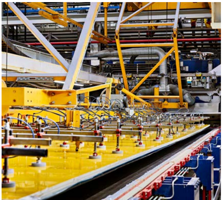
Der Fertigungsprozess für den Cool Liner ist gleich geblieben, Seitenwände und Dach werden als Ganzpaneel hergestellt, der Boden im Injektionsverfahren.
