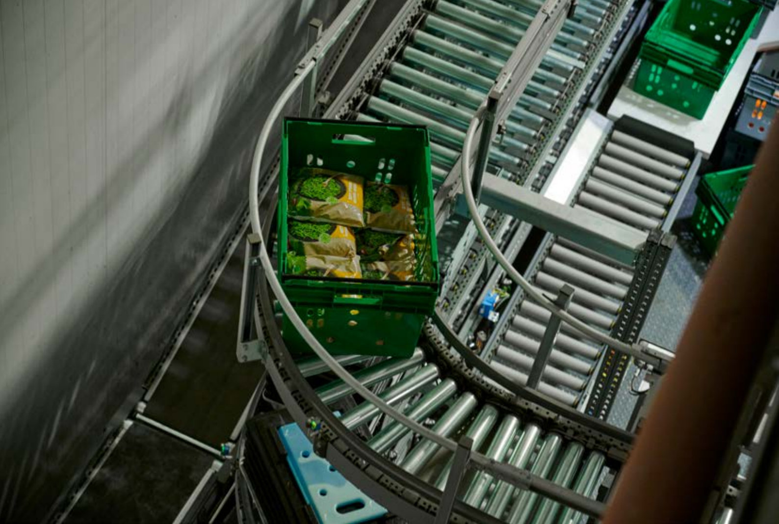
Frozen Artikel bei Shufersal lagern zusammen mit den Kühlelementen im Evo Shuttle.
