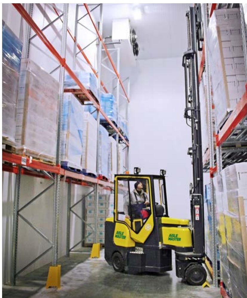
Der Aisle Master ermöglicht Hubhöhen bis zu 15 Meter.
