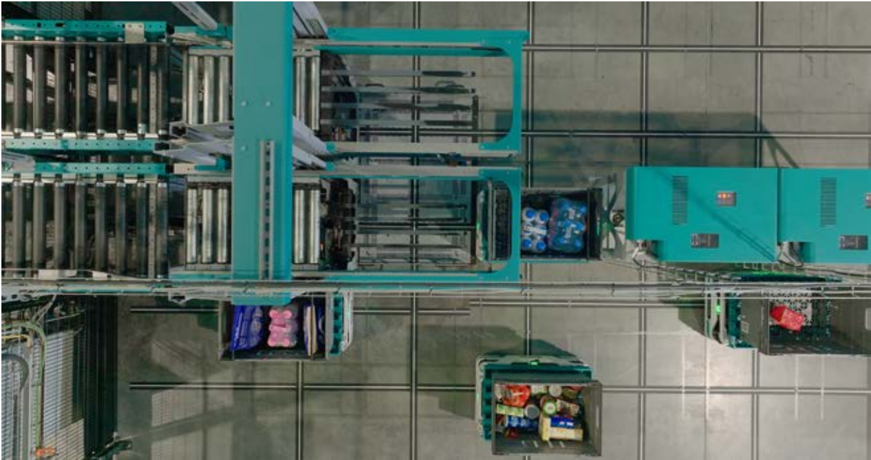
Auf einer Lagerfläche von 2500 Quadratmetern verwalten die Skypod-Roboter Behälter für Produkte in Raumtemperatur, Frische und Tiefkühlung
