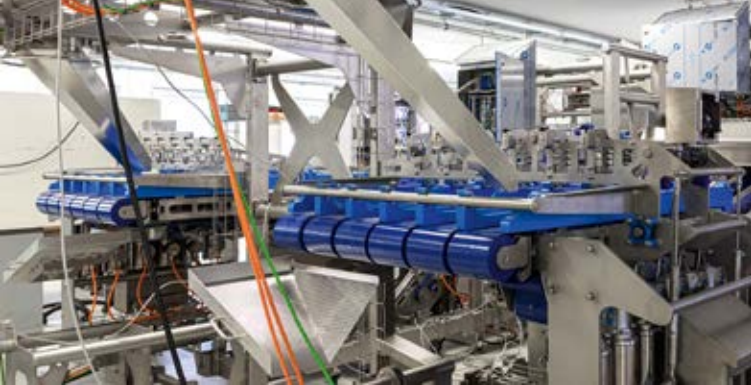
Die Anlage ist doppelläufig mit zwei gespiegelten Linien aufgebaut. Beide sind durchgehend mit sechs Transportspuren versehen.
