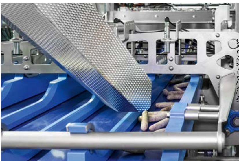
Über die Verteilerrutsche gelangen die Würste unsortiert und chaotisch auf die erste Bandstation.
