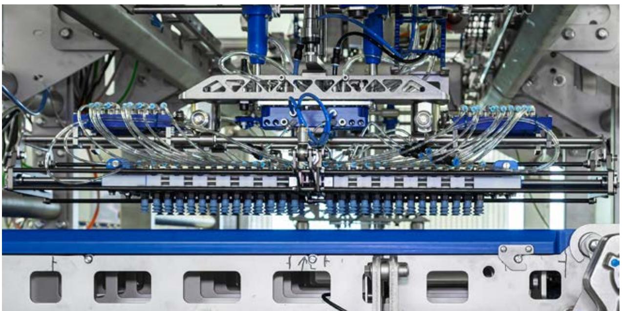
Ein Spezialgreifer auf jeder Linie saugt am Ende der Anlage die Würste an und legt sie in die Verpackungsmaschine ein.
