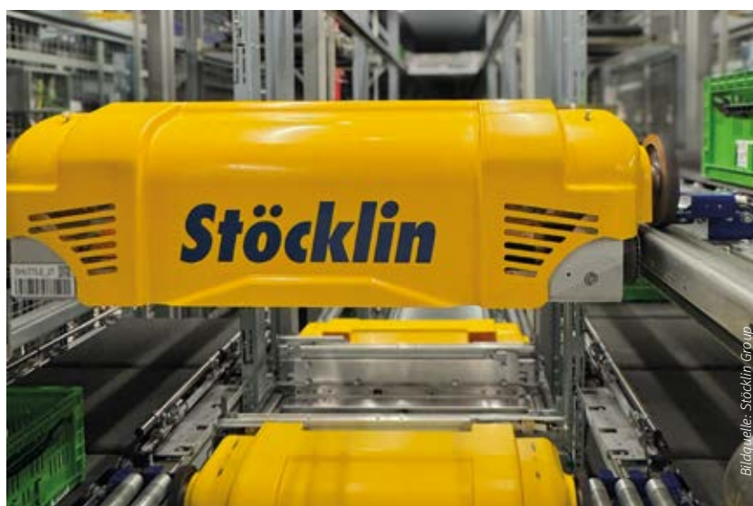
Vorteil der AKL FSP Shuttle Systemlösung ist, dass die Fahrzeuge jeweils nur auf einer Ebene fahren.
