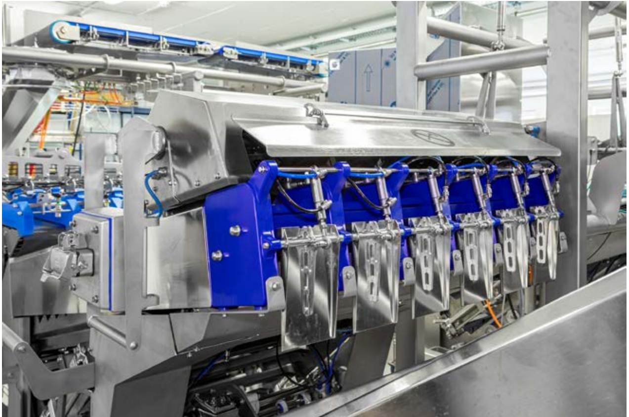
Am Ende des ersten Stufenförderers erfolgt der »Wurstcheck« durch eine Kamera auf jeder Spur: Im Fall von Abweichungen bei Länge oder Konturen beziehungsweise bei Beschädigungen wird die Wurst nach unten in einen Behälter »ausgeflippert«.
