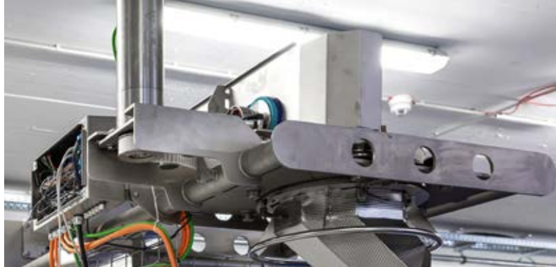
Über einen Zahnriemen dreht ein Edelstahl-Servogetriebemotor die Schütte so um ihre vertikale Achse, dass die sechs Spuren eines Förderbandes gleichmäßig mit den Würsten befüllt werden.
