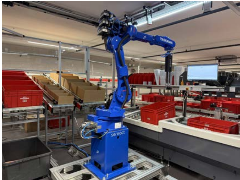
Cortex kommissioniert Artikel ohne Anlernen und mit nach Herstellerangaben stabilen 250 bis 300 Picks pro Stunde.
