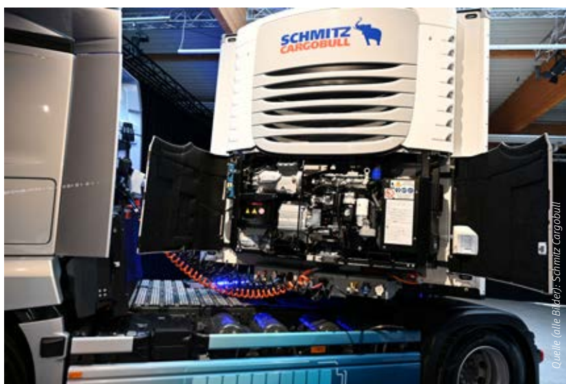
Die Transportkältemaschine S.CU dc90 und S.CU d80 können dank ePTO über den elektrischen Nebenabtrieb der Sattelzugmaschine emissionsfrei betrieben werden.
