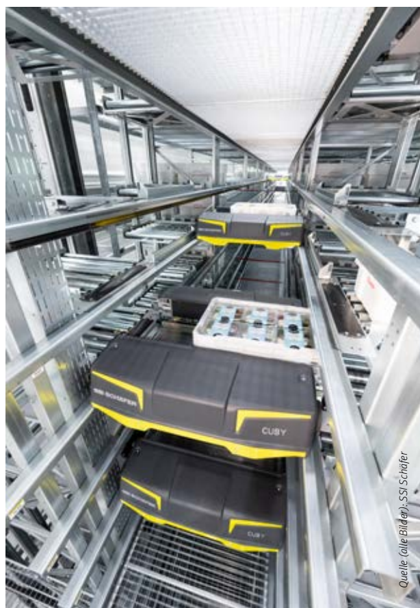
Das Shuttle-System bietet 10.500 Behälterstellplätze in zwei Gassen und sorgt mit 58 Shuttles für schnellen, sicheren Materialfluss bei idealen Temperaturen im Kühlager für verzehrfertige Frischsalate.
