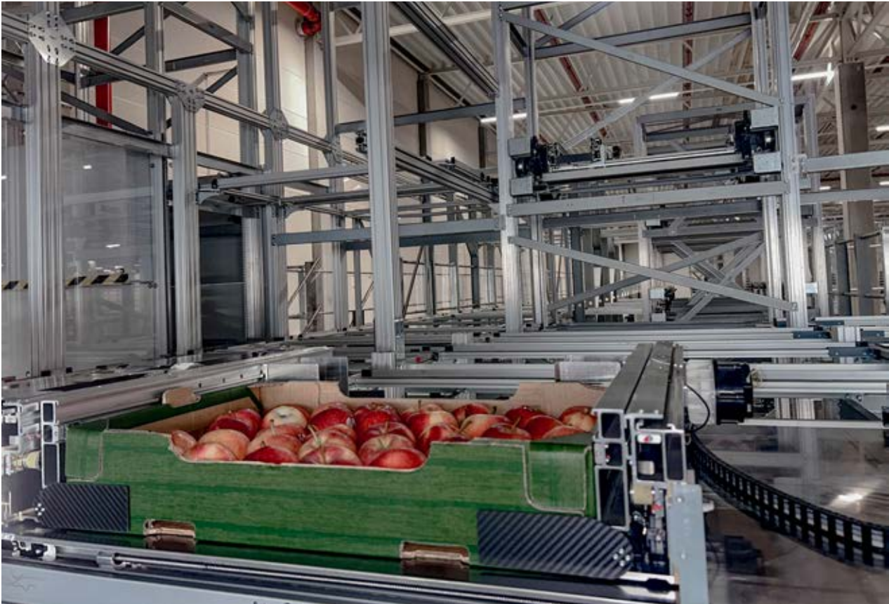
Zu den Hardware-Komponenten der Advasolutions-Lösung gehören Shuttles, Racks und Shelves.
