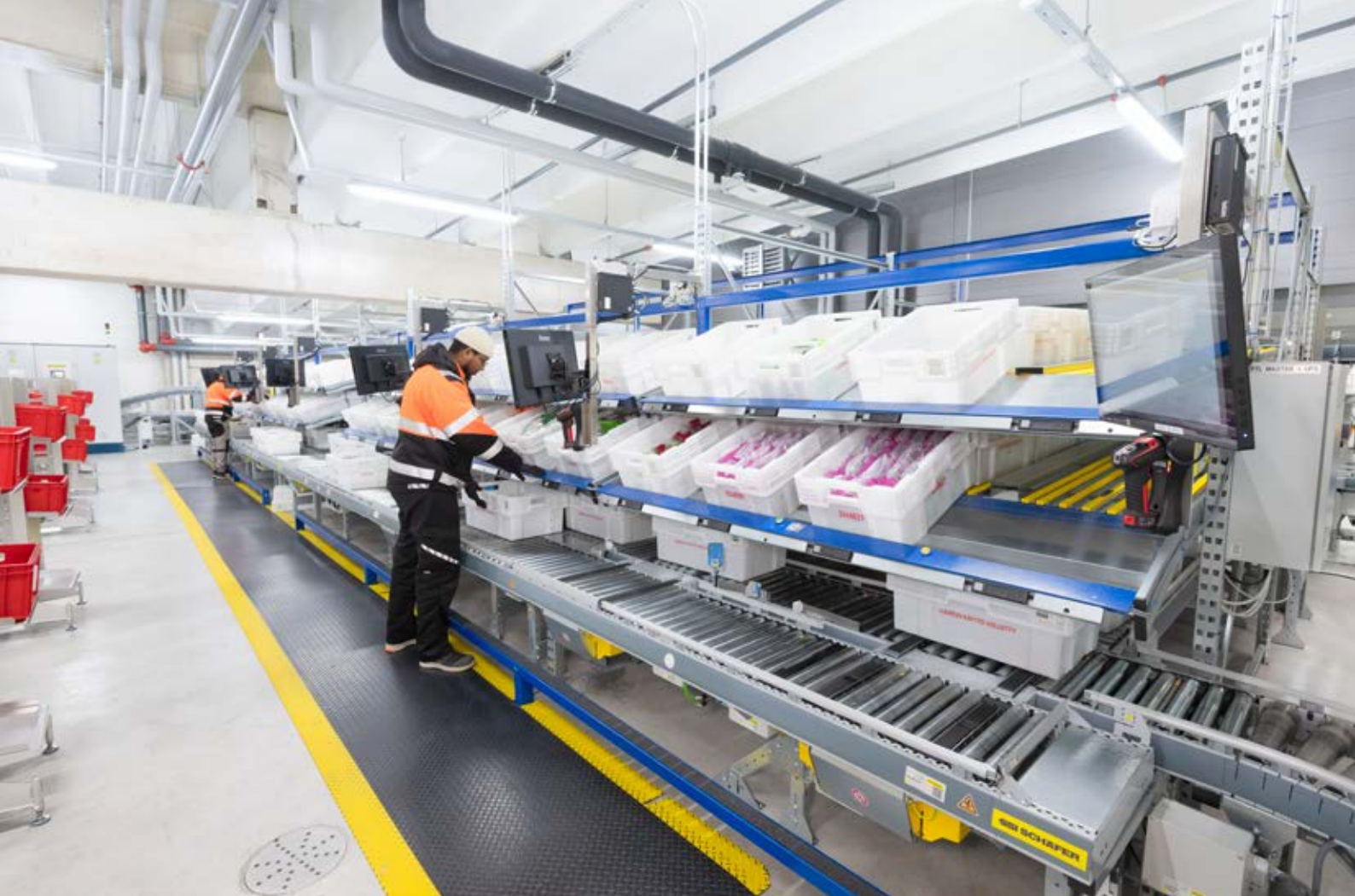
In der neuen Logistiklösung liegt der Fokus auf ergonomischen Arbeitsplätzen: Ein flexibler Kommissionierbereich für ein bis fünf Personen nutzt das Pick by Light System für Mittel- und Langsamdreher.
