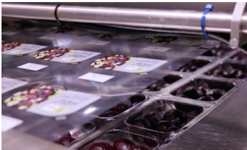
Bei G's stellt jetzt eine Komplettlösung luftdicht verschlossene, halbstarre Rote-Beete-Verpackungen mit einer Peel/Wiederverschlussfunktion her.
