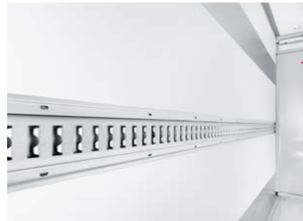
Als Vorteil des Herstellungsverfahrens nennt Kiesling auch, dass Ankerschienen in die Seitenwand voll integriert sind.
