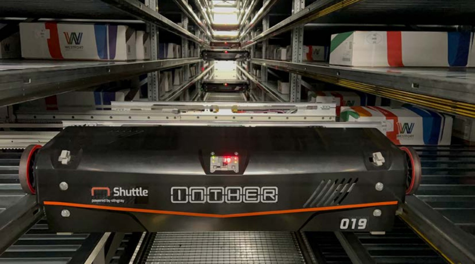
Bei Abruf zur Auftragskommissionierung werden die Kartons von den Shuttles aus dem Pufferlager an eine Fördertechnik ausgelagert.
