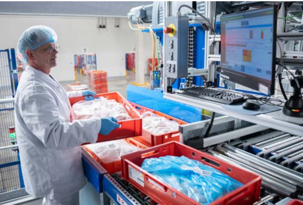
Mitarbeiter erhalten vom Lagerverwaltungssystem Uniware übersichtliche Handlungsanweisungen über Bedienerdialoge und Staplerterminals.
