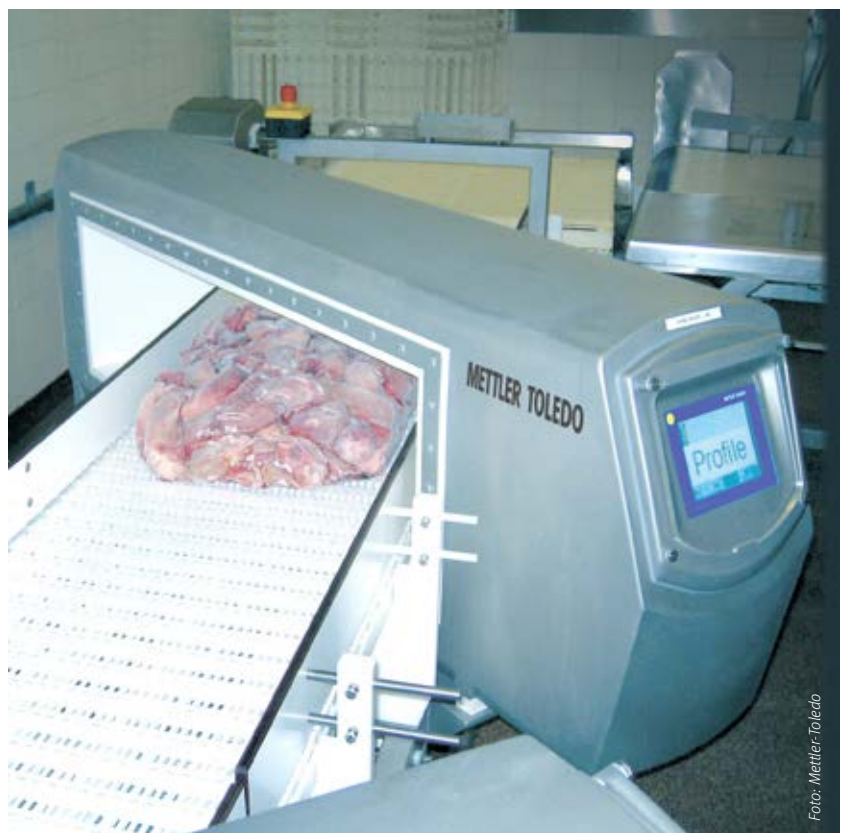
Auch wenn die Produkte selbst absolut sicher sind, verändern bereits geringfügige Temperaturschwankungen von TK-Produkten das Signal der Produkte beim Passieren eines Metallsuchers.
