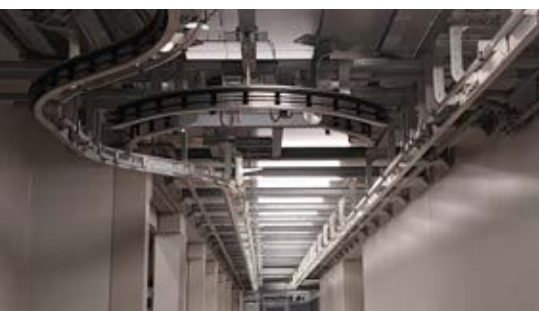
270 Meter Elektrohängebahn hat Vahle für Westvlees elektrifiziert.
