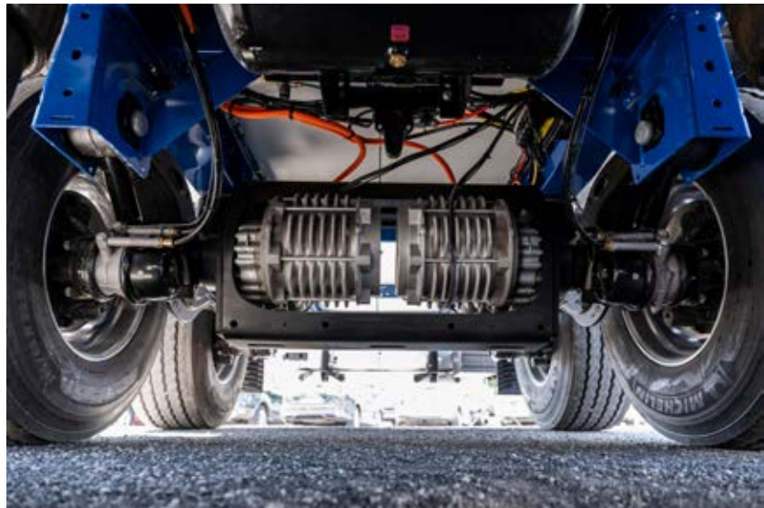
Im Außengelände präsentiert Krone den Cool Liner mit Thermo King Advancer A-500e AxlePower als vollelektrisches Kühlsystem.
