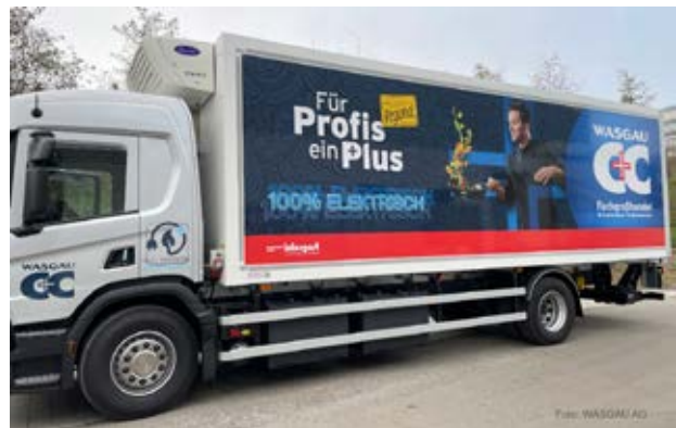
Wasgaus neue Scania-E-LKW mit Dreikammer-Kühl Aufbau werden an insgesamt sechs DC-Ladepunkten mit Strom versorgt.
