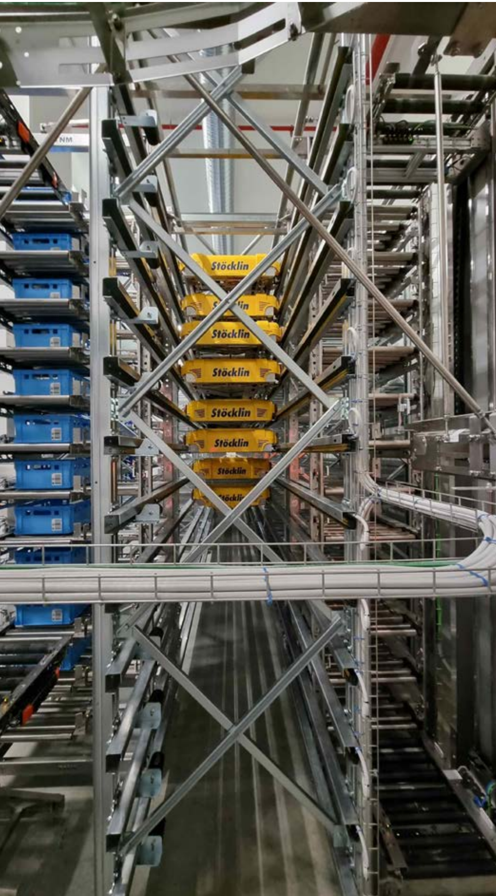
Die 2-in-1 Speziallösung für Pfitscher Burgstall: Ein eingassiges Gebindestapel-Kannallager (GKL) in Kombination mit einem eingassigen FSP-Shuttle-Lager.
