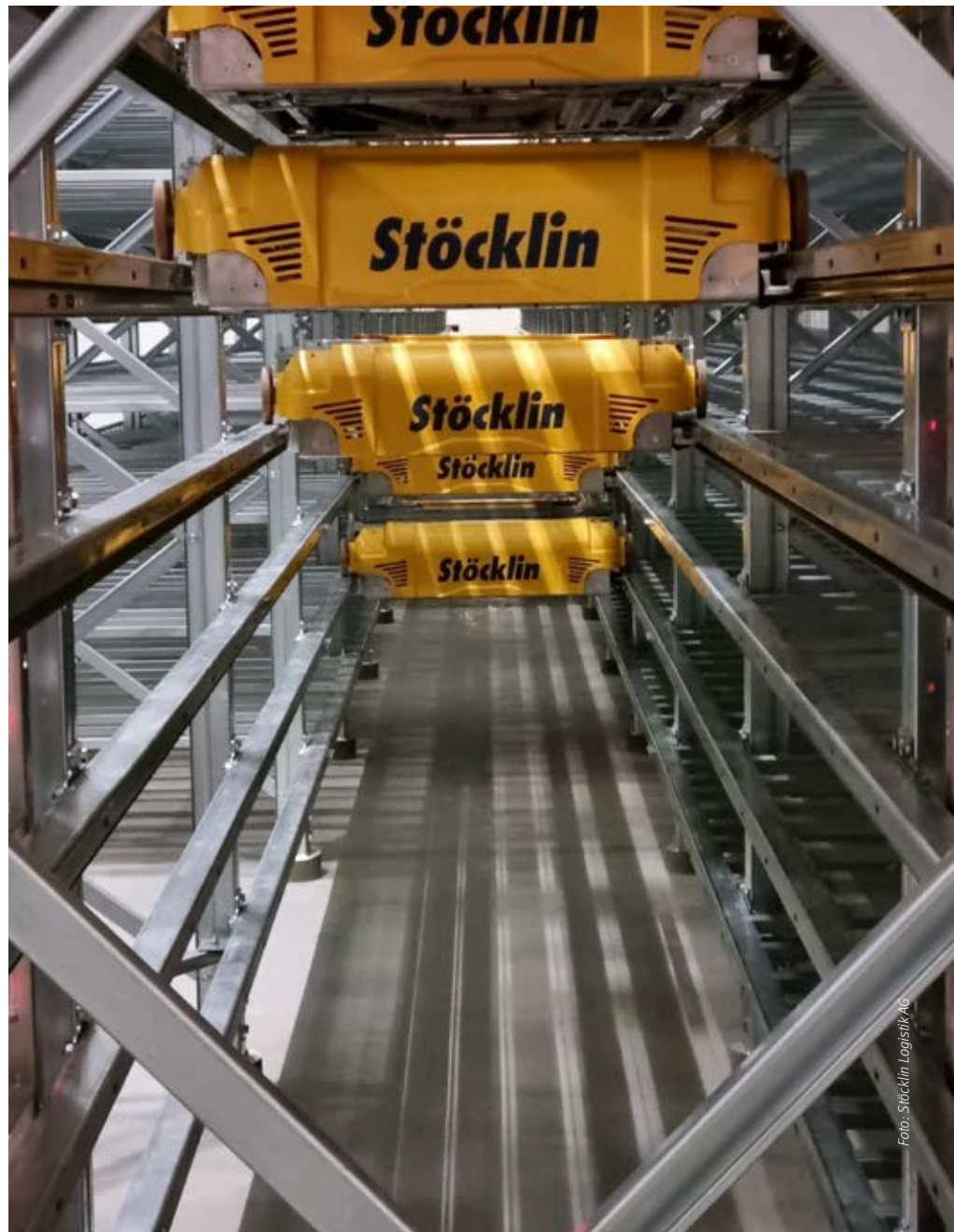
Das FSP-Shuttle-Lager für den Tagesbedarf der Kommissionierung von frischen und konfektionierten Produkten.
