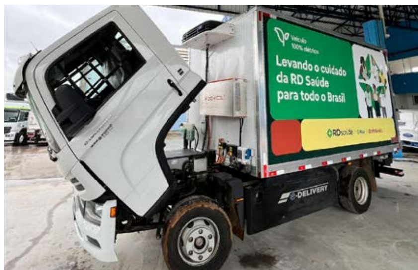
Bereit für den Einsatz in Brasilien: E-LKW von Volkswagen do Brasil mit Addvolt-Batteriesystem für die Versorgung der Transportkälte.
