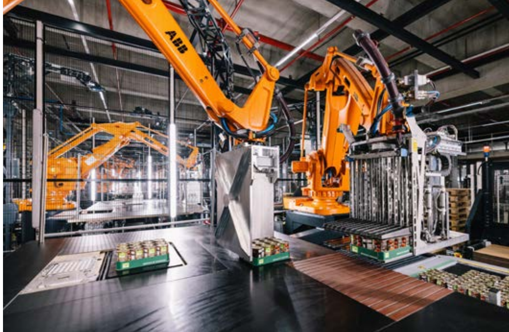
Zwölf Roboter-Greifarme stellen filialindividuell Paletten zusammen.
