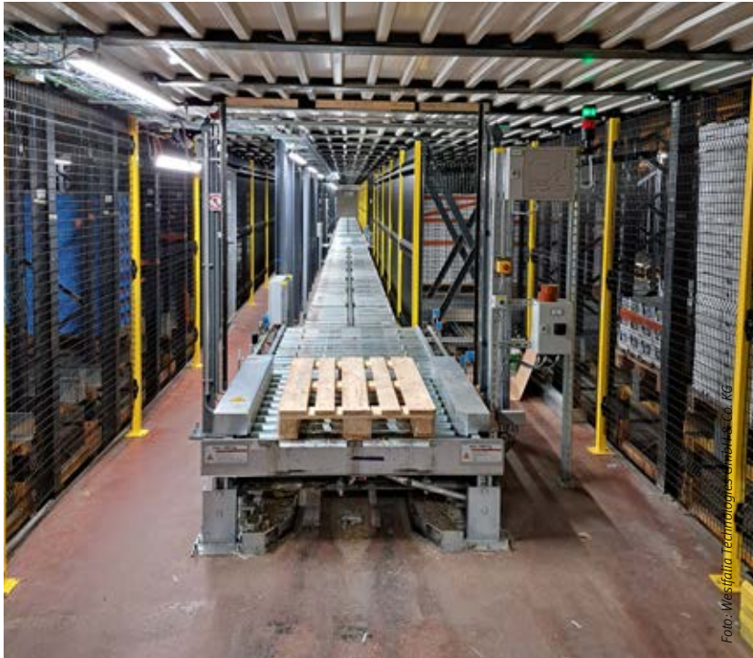
Blick von der Aufgabe aus auf den neuen zentralen Förderstrang im Frischelager: Er wurde zwischen den Regalbediengeräten entlanggeführt und transportiert Waren von der Produktion ins Lager und in die neuen Kommissionierhallen. Hintereinander angeordnet sind Konturen- und Gewichtskontrolle.
