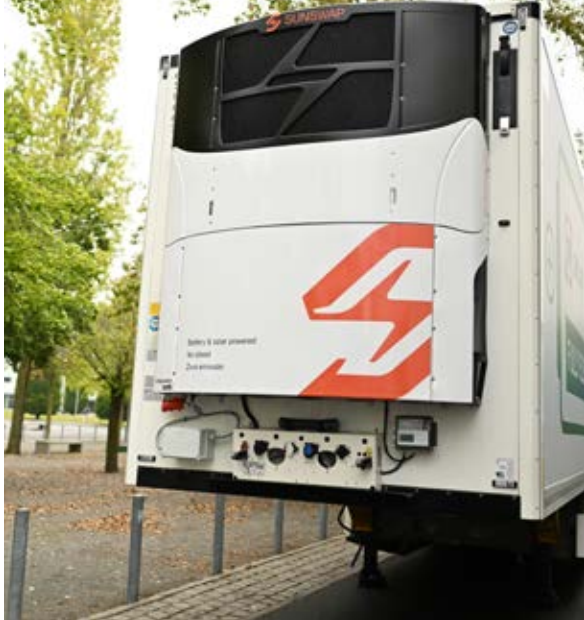
Sieht aus wie ein »normales« Transportkälteaggregat, setzt aber voll auf Batterie und Photovoltaik: »Endurance« von Sunswap.
