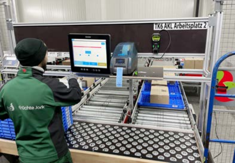
Ergonomisch gestaltete Kommissionierarbeitsplätze minimieren das Bücken und das Heben schwerer Kartons.
