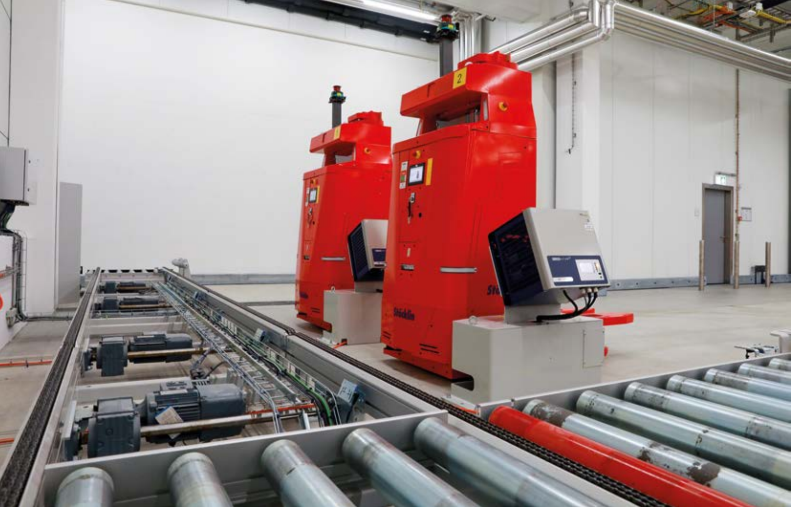
Für die zweistöckige Palettenlagerung speziell ausgelegte selbstfahrende Transportfahrzeuge Typ Eagle-Ant 2 von Stöcklin.
