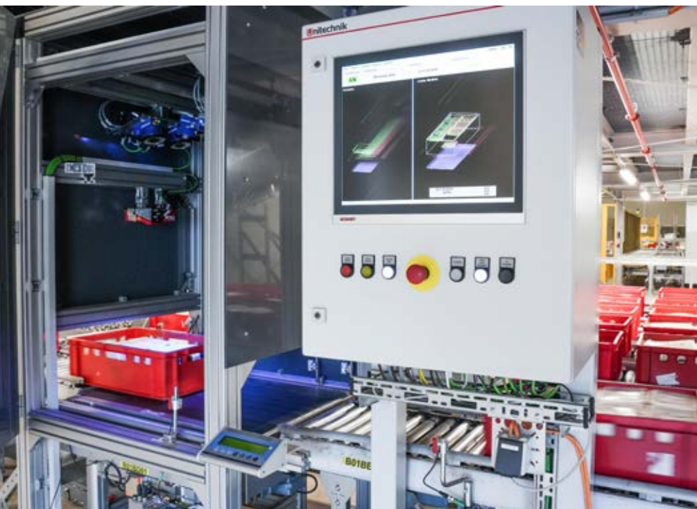
Ein vollautomatisches Vermessungssystem prüft E2-Kisten auf Förderfähigkeit.
