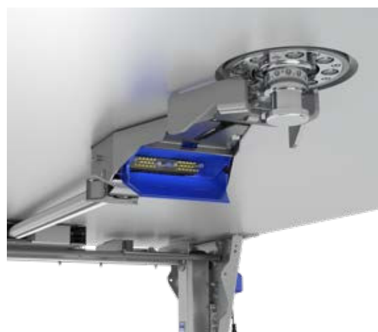
Das neue KKS-Cool kuppelt auch Kühltrailer automatisch an die Zugmaschine.
