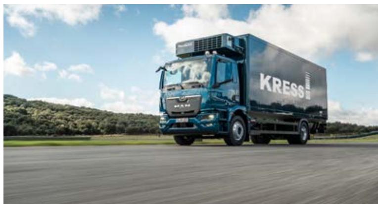
Die Coolerbox von Kress hat eine aerodynamische Stirnwand.
