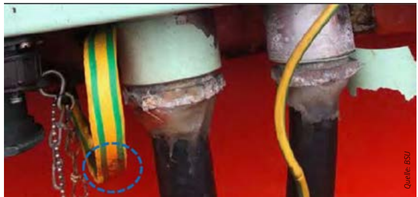
Korrodierte Abschnitt des Hauptleitungskabels unterhalb des Gehäusekastens an Bord der Montreal Express.
