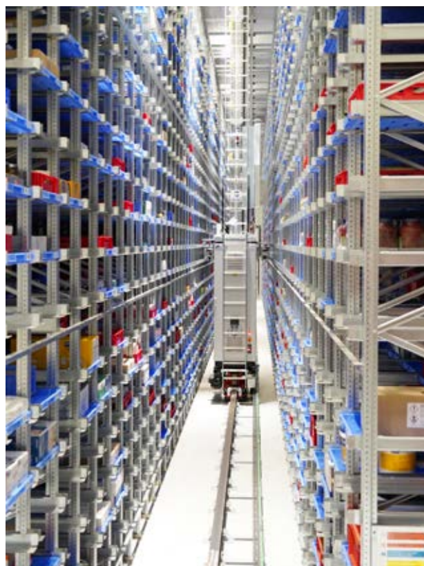
Automatisches Kleinteilelager mit Regalbediengerät.
