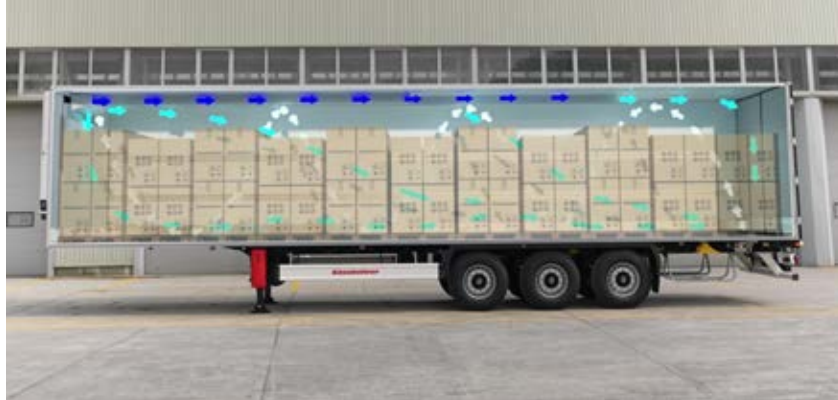
Luftzirkulation im neuen Kühlkoffer von Kässbohrer.
