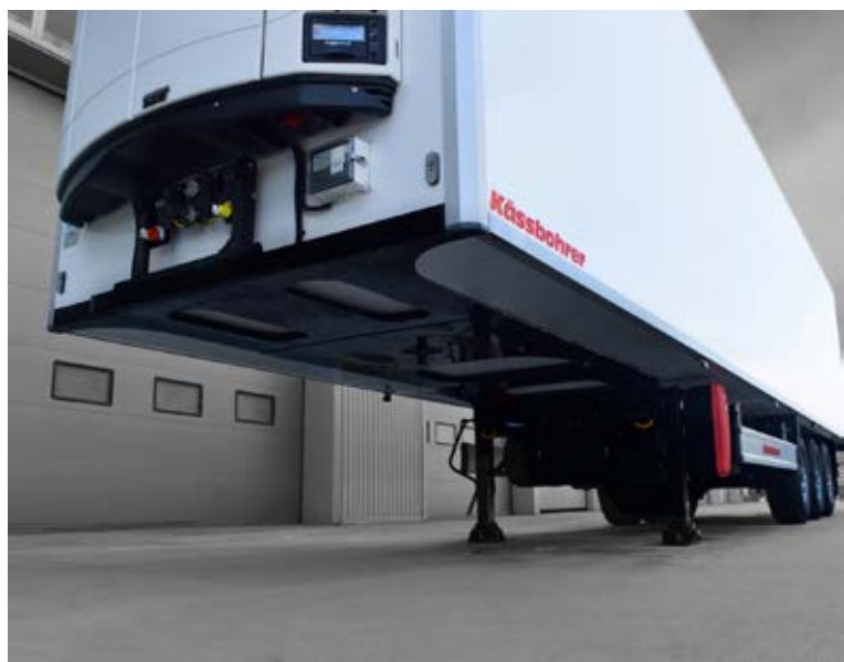
Das Chassis der neuen Kühlauflieger ist aus hocheffizientem Struktursteel und hochreinem S700MC-Stahl gefertigt.
