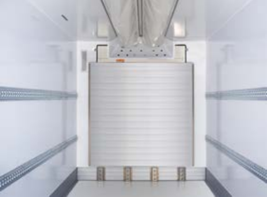
Die patentierte Luftzirkulationswand von Kässbohrer ist faltbar.
