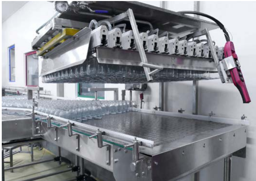
Neuglas wird von der Palette auf das Transportband gesetzt, mit gereinigtem Gebrauchsglas gemischt und anschließend in die Produktionshalle transportiert.
