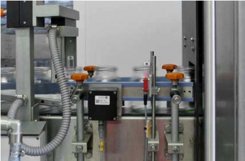
Der Leerglasinspektor prüft den Mündungsbereich, die Seitenwand und den Boden der Gläser auf transparente Fehler sowie das Vorhandensein von Restflüssigkeiten.
