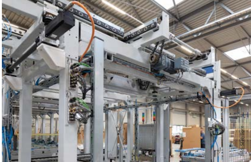
Ein Hubtisch mit zwei Spindeln wird an jeder Seite mit jeweils einem SEW-Synchronmotor CM3C mit Movilink-DDI-Geber und Einkabeltechnik zwischen Motor und Umrichter angetrieben.
