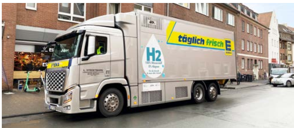
Der Hyundai Xcient Fuel Cell wird mit Wasserstoff betrieben und ist mit Frigoblocks FK25i ausgestattet
