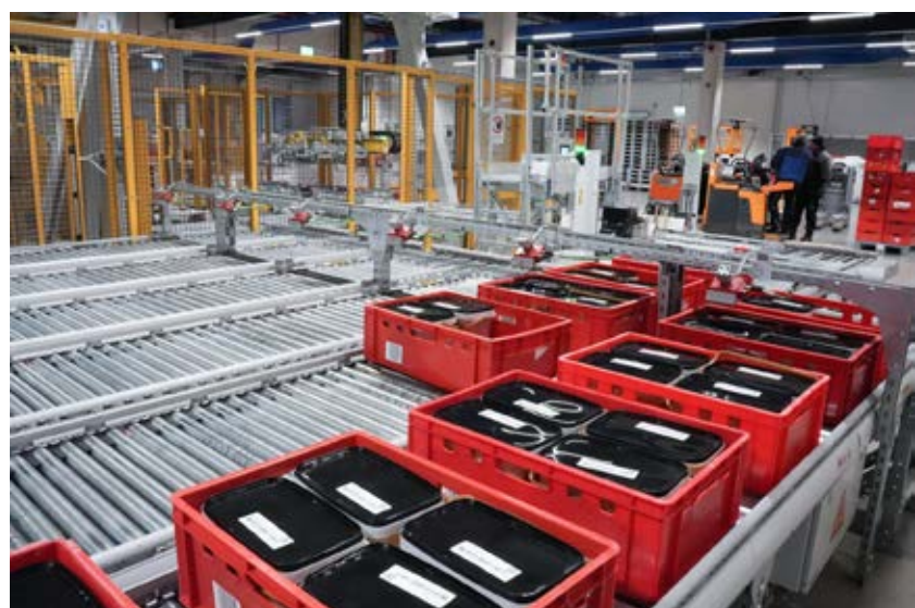
Die Warenausgangsharfe besteht aus sechs parallelen Förderstrecken und stellt die Aufträge bereit.
