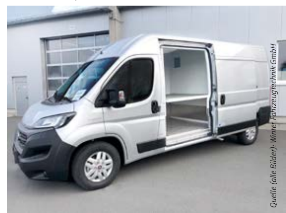
Winter Kühlfahrzeug mit zusätzlicher Schiebetür auf der Fahrerseite.
