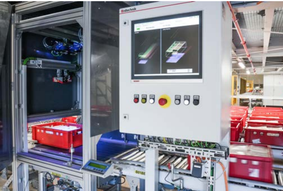
Das Box-Geometry-Check-System (BGC) prüft jede Box noch vor der Einlagerung auf Verformungen und Ausbrüche.
