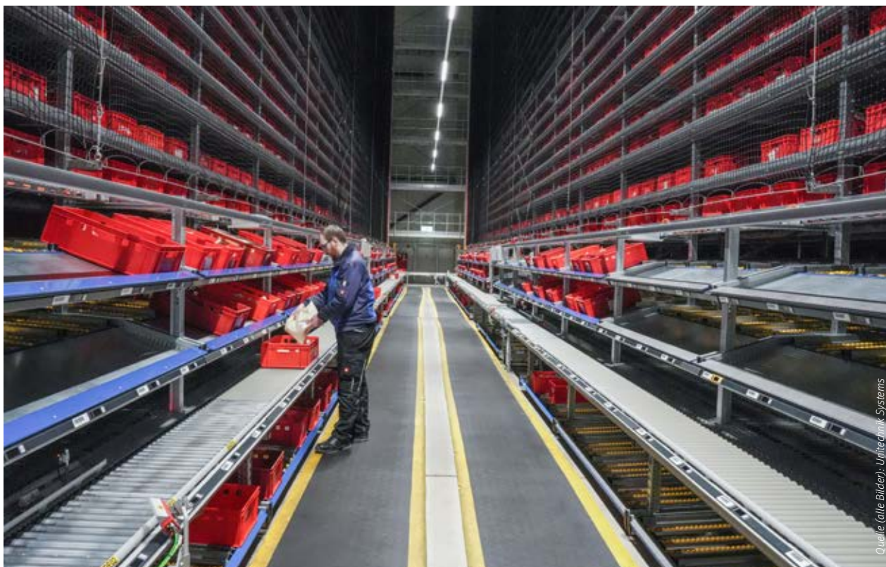
Das Shuttlelager bei Sander Gourmet versorgt 488 Durchlaufkanäle, die mehrere Kommissionier-Bahnhöfe bilden.
