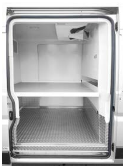
Zweite Ladeebene im Schiebetürbereich dank herausnehmbarem Zwischenboden.
