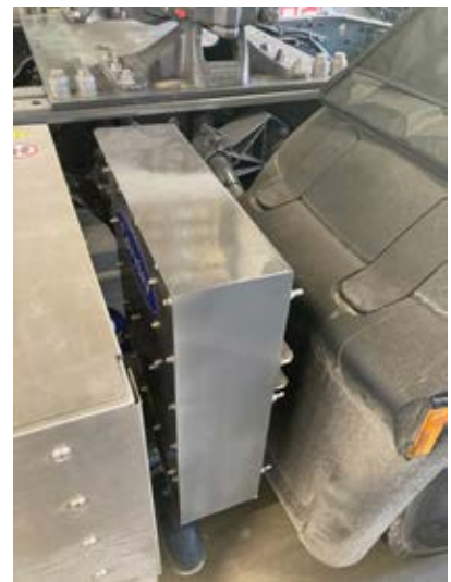
Die Carrier Powerbox wandelt den 700-Volt-Gleichstrom des Brennstoffzellen-Antriebs in 400-Volt-Drehphasenstrom für den Betrieb des Kühlsystems im Auflieger um.
