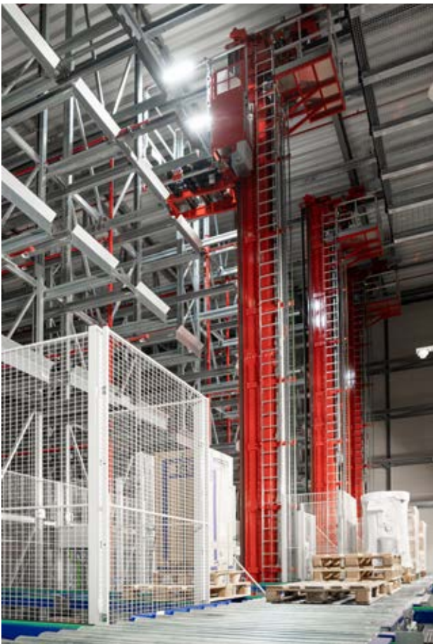
Mehrere Gilgen Performance RBGs in einem Hochregallager.
