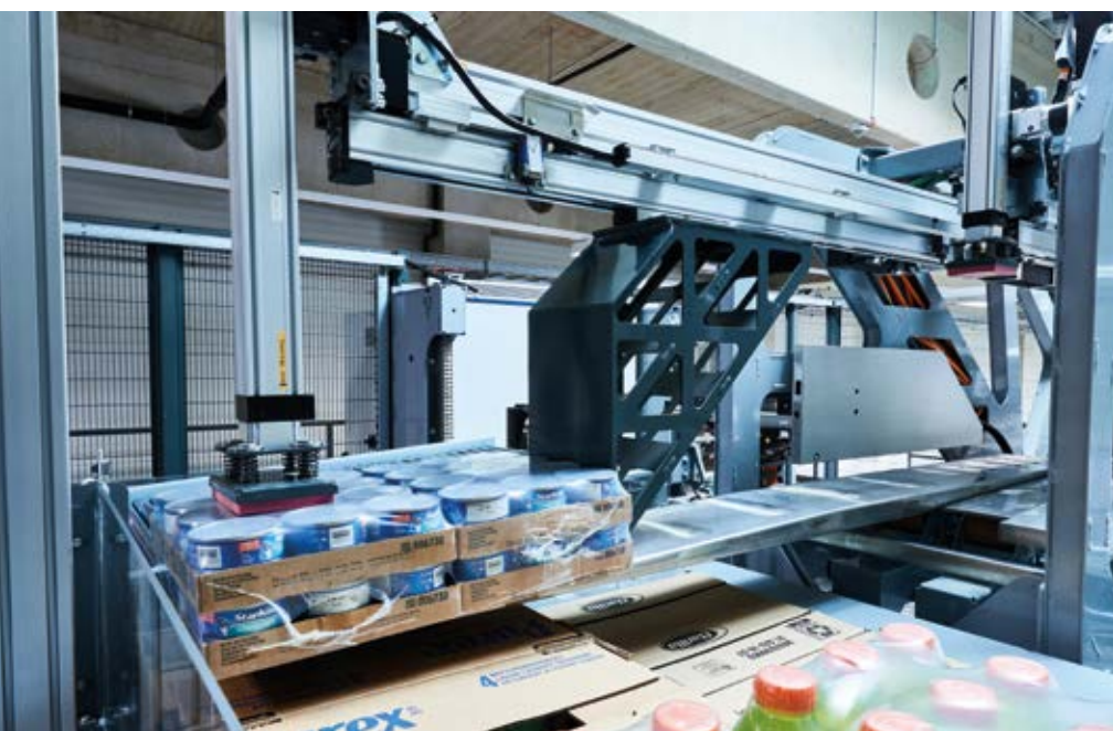
Runpick kommissioniert das gesamte Sortiment an Lebensmitteln vollautomatisch.
