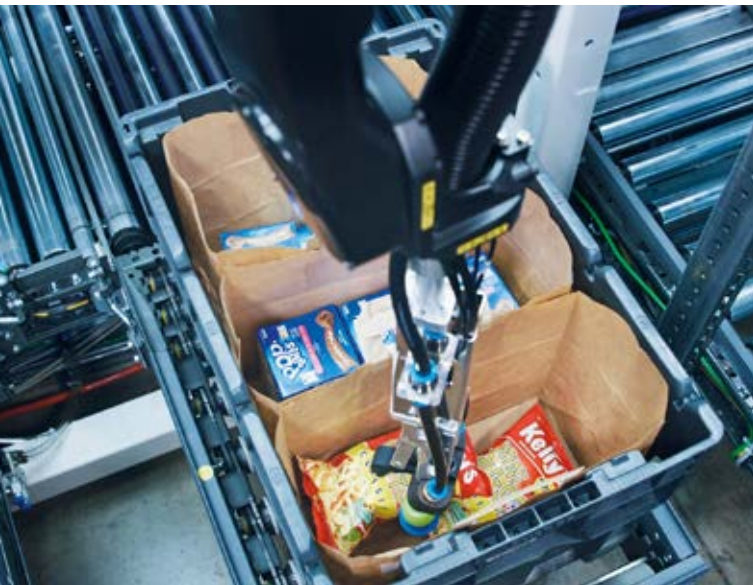
Dank seiner Kamerasysteme kennt der Pick-it-Easy Robot auch den besten Platz in der Tüte. Schwere, weniger empfindliche Artikel legt er als Erstes ab, die mit weniger Gewicht weiter oben.
