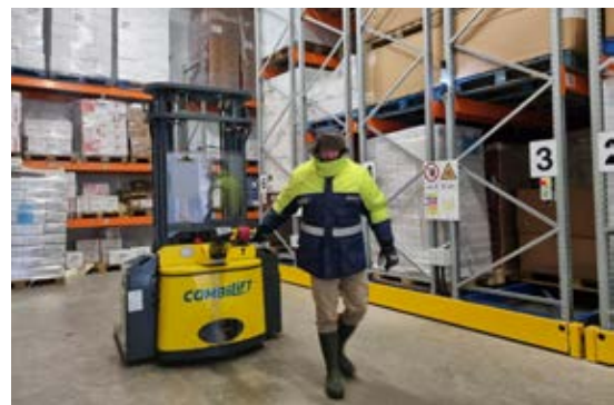
Der Combi-WR verfügt über eine patentierte und preisgekrönte Mehrstellungsdeichsel.
