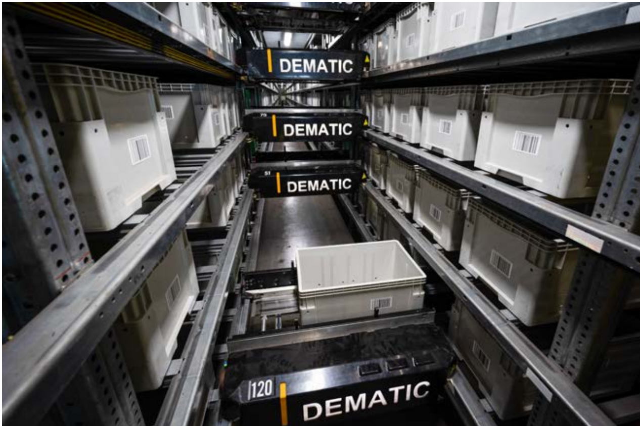
Die automatisierte Lösung setzt Shuttles ein, um Produkte automatisch ein- und auszulagern und sie zu den Ware-zur-Person-Arbeitsplätzen zu bringen.
