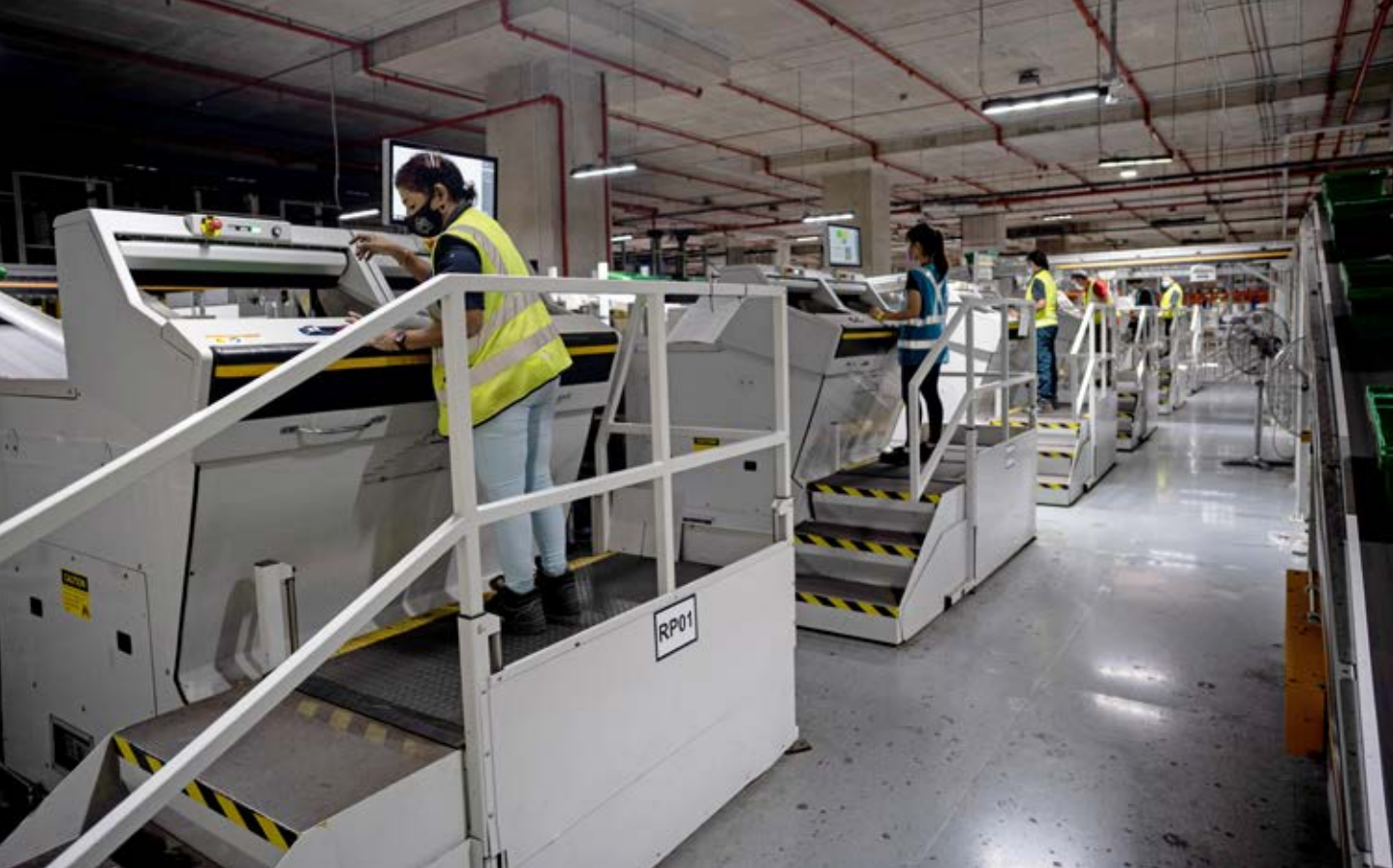
Der Bediener bleibt an einem Ort, während die Artikel automatisch an seine Kommissionierstation geliefert werden.
