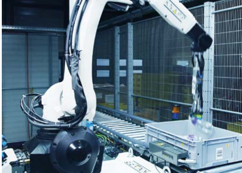
Pick-it-Easy Robot kommissioniert mit speziell entwickelten Greifern die teils empfindlichen Lebensmittel schonend und legt sie behutsam ab.
