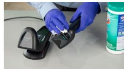
Der Datalogic Gryphon I GD4520 2D Imager mit desinfizierbarem Gehäuse.
