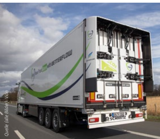
Dieser aerodynamisch optimierte Trailer wird im Pilotversuch getestet.
