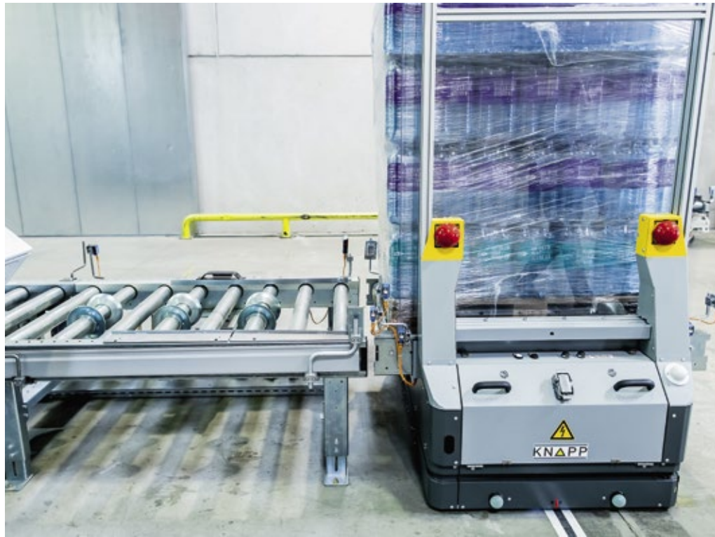
Die Open Shuttles sind autonome, mobile Roboter des Automatisierungsspezialisten Knapp.
