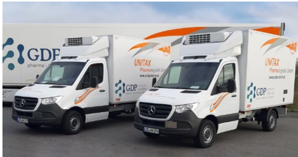
Mercedes Sprinter von Unitax mit GDP-Kühlkoffer und Thermo King V500 Kühlaggregat für den Transport von Impfstoffen.
