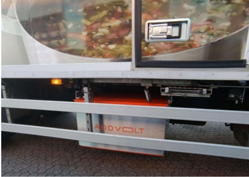
Das Addvolt-System versorgt das Kühlaggregat mit Strom, es kann bei jedem Lieferstopp aufgeladen werden, indem das Fahrzeug an das Stromnetz angeschlossen wird.
