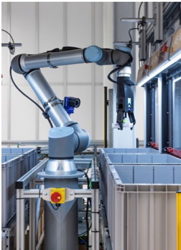
Ein vollautomatischer Roboter kommissioniert aus sechs Behältern in einen Zielkarton.
