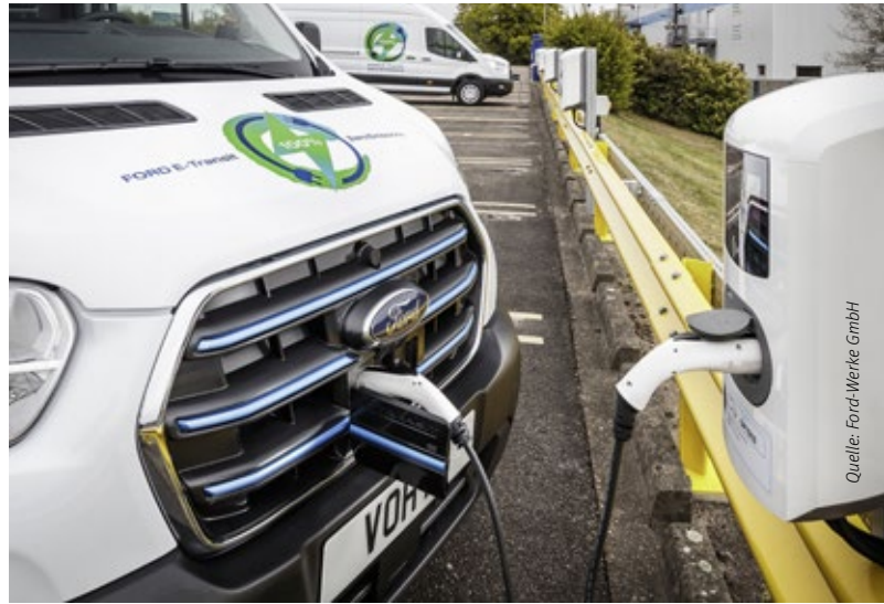
Die nutzbare Batteriekapazität des E-Transit von 67 kWh (400 Volt) verhilft dem Fahrzeug laut Ford zu einer voraussichtlichen Reichweite von bis zu 350 Kilometern (kombiniert) gemäß WLTP-Fahrzyklus.
