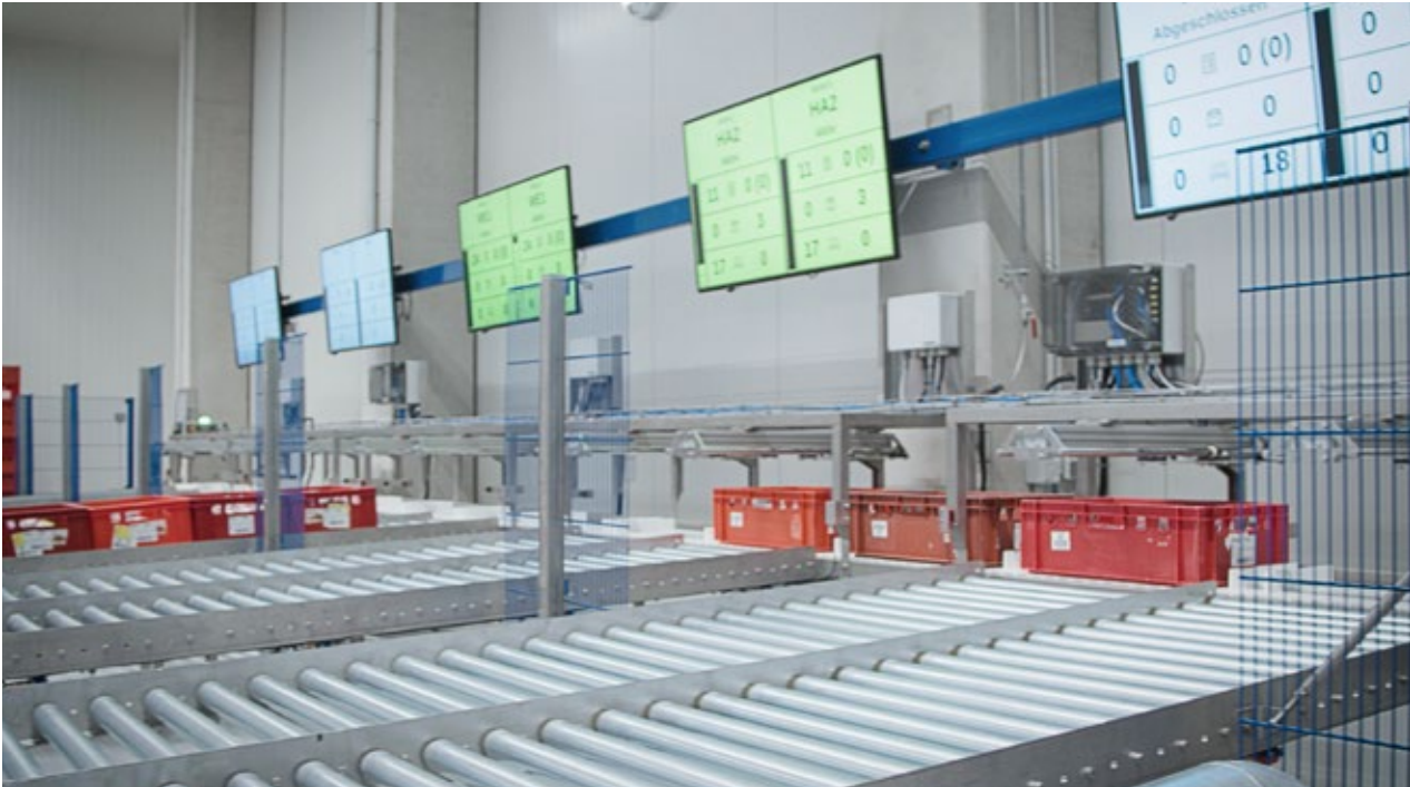
SLA sorgt bei Kröswang für vollautomatischer Prozesse vom Wareneingang über Kommissionierung bis hin zur Verladung.
