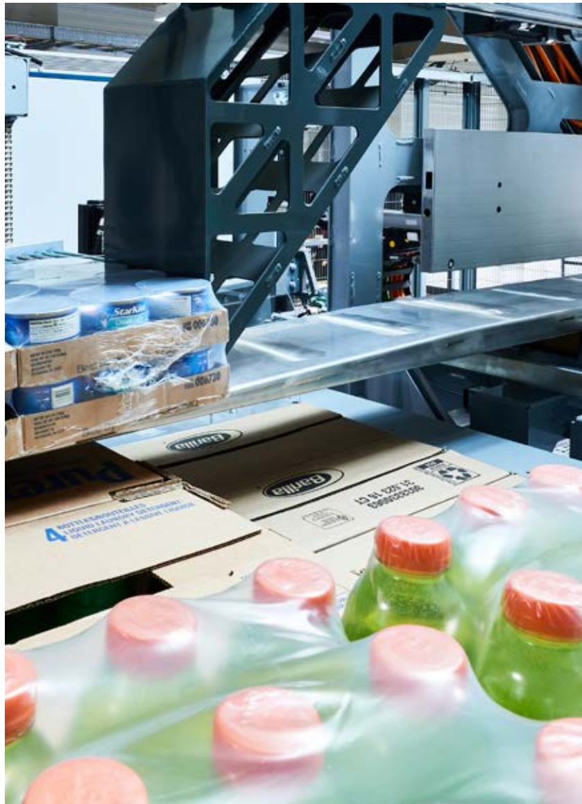
Das vollautomatische Kommissionier- und Palettiersystem Runpick.
