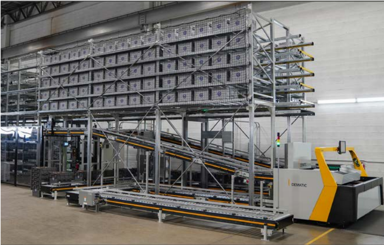
Die Dematic Micro-Fulfillment-Lösung stellt Online-Bestellungen innerhalb einer Stunde zusammen.
