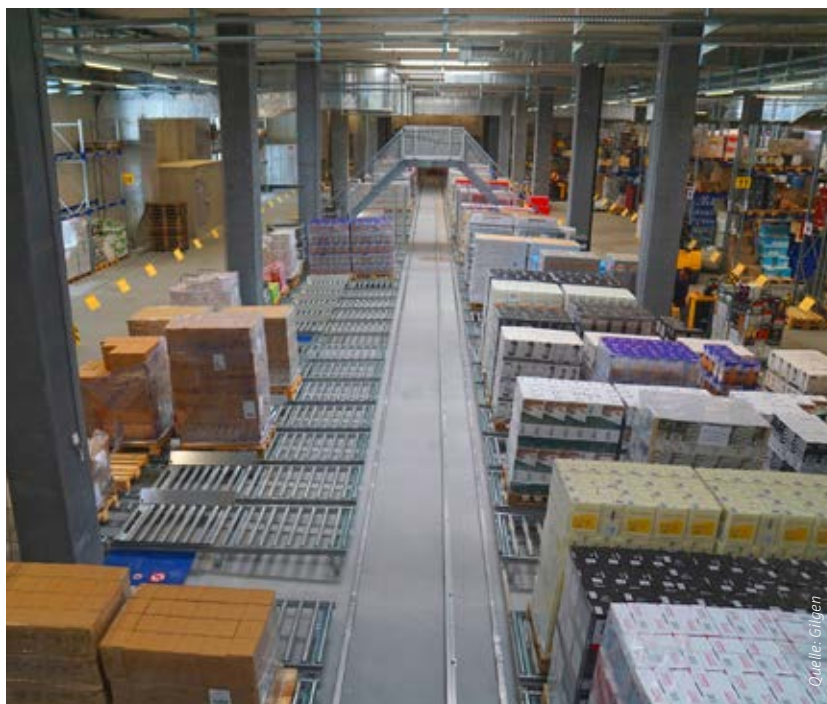
Erledigte Rüstaufträge werden auf die Rollbehälter-Fördertechnik aufgegeben und gelangen über Verbindungsstrecken direkt in die Bahnhof oder zur LKW-Entnahmestelle.
