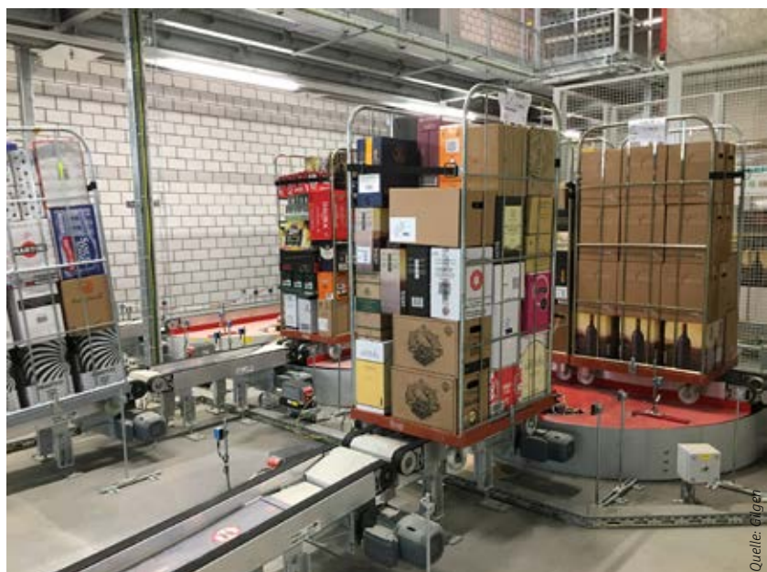
Aus dem Hochregallager werden Nachschubpaletten für die Kommissionierung über Hochleistungsverschiebwagen bereitgestellt.
