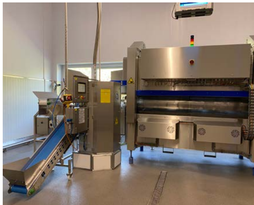
Der Zip-Roll-Froster hat eine Größe von 4 mal 2 mal 3 Metern und lässt sich problemlos in bestehende Produktionslinien integrieren.
