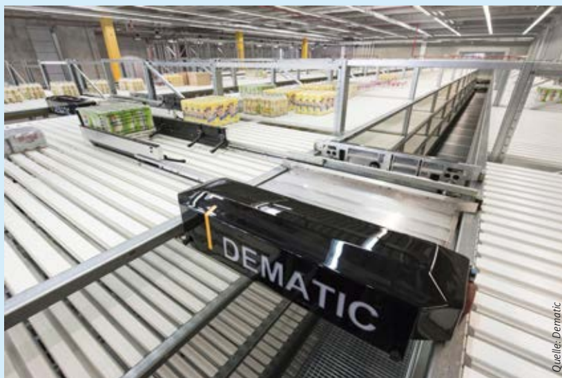
Das Dematic Multishuttle sorgt für die Pufferung und die optimierte Sequenzierung bei dichter Lagerung.
