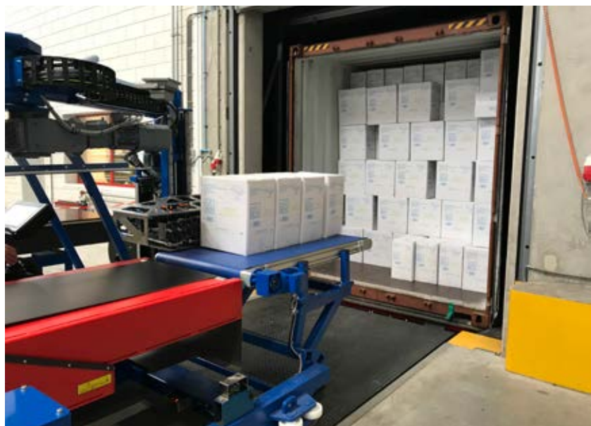
Das Containerentladesystem von Copal bei der Arbeit.
