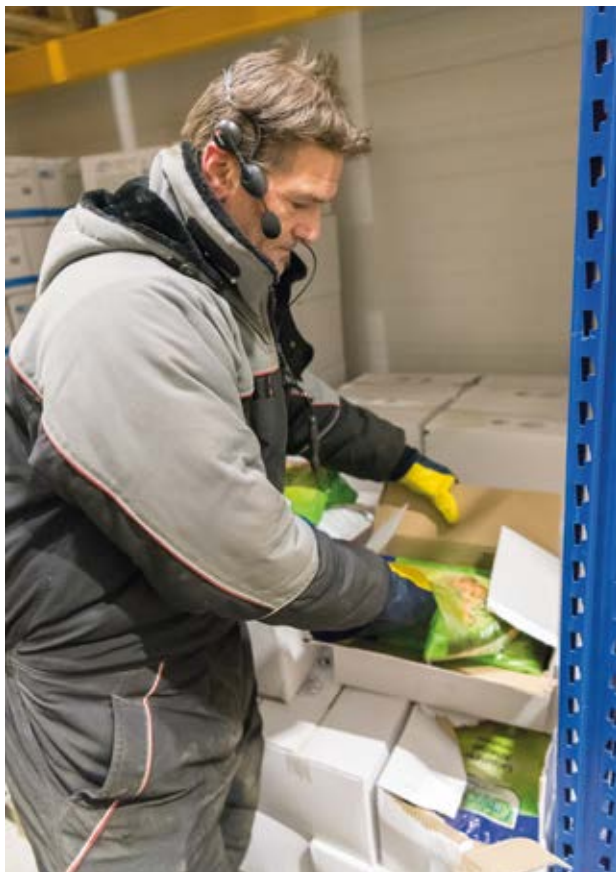
Im TK-Lager wird bei Rullko jetzt sprachgestützt kommissioniert.
