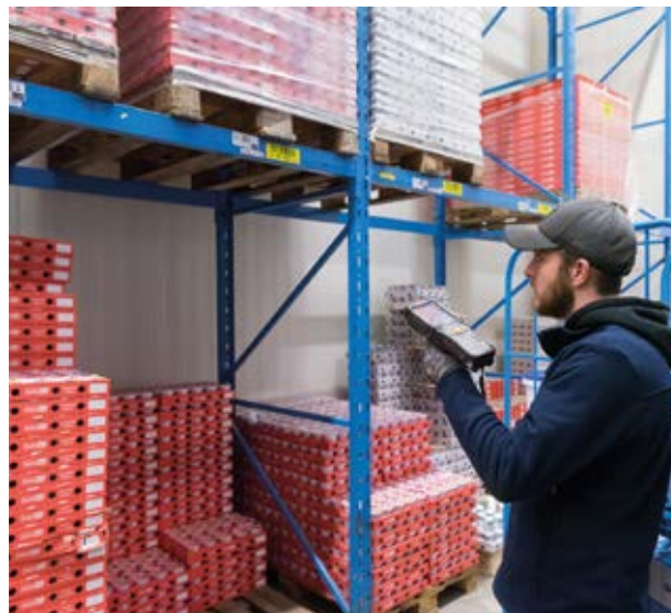
Im Bereich der Kommissionierung kommen robuste und handlich konzipierte Datenerfassungsgeräte zum Einsatz.
