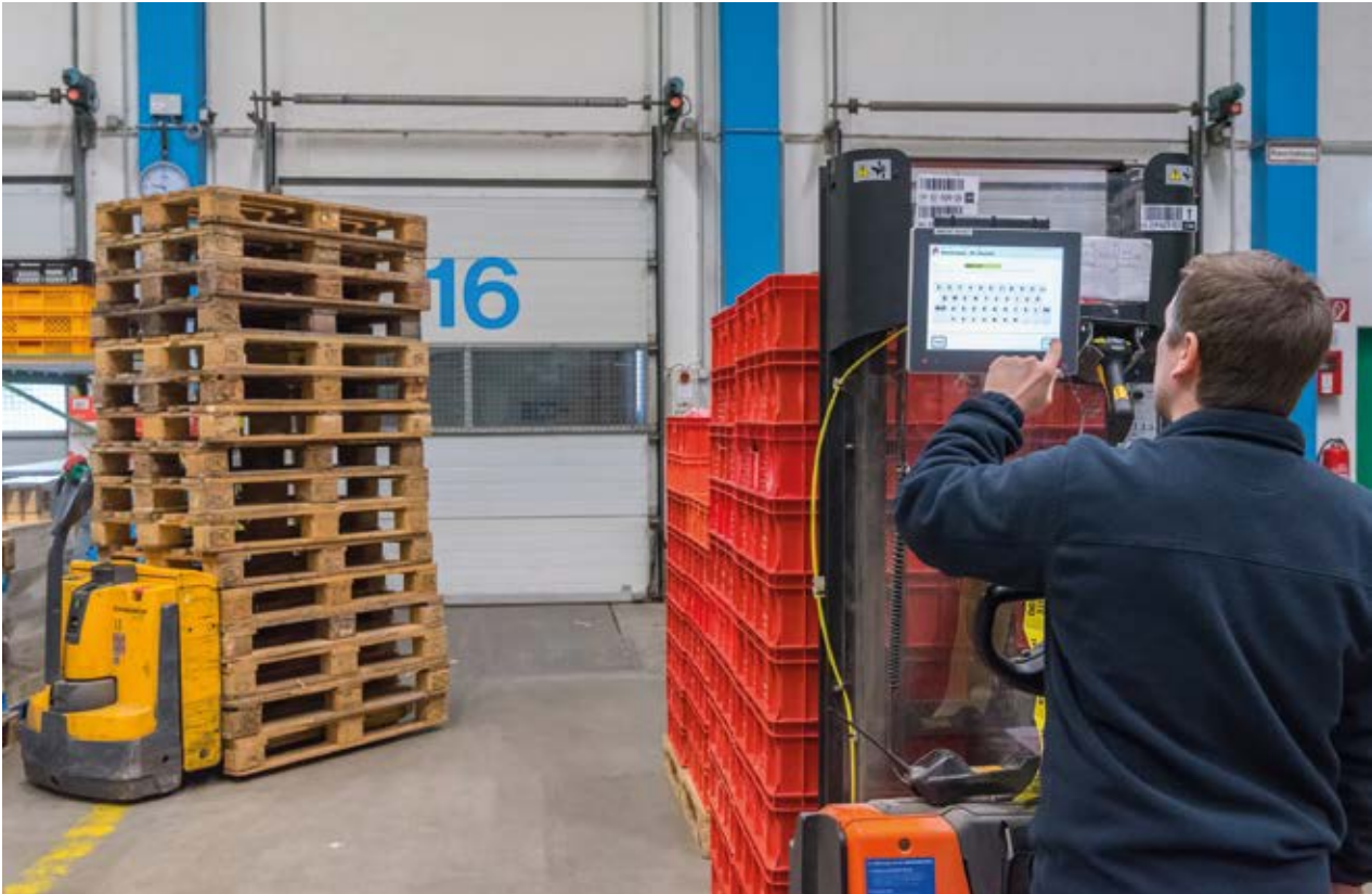
Die Stapler, die die Transporte im Haupt- sowie im TK-Lager übernehmen, sind im Zuge des Projekts mit Bordcomputern ausgerüstet worden.
