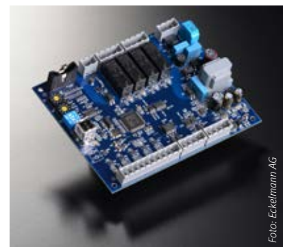
Seine neuen Virtus Line OEM-Regler für steckerfertige Kühlmöbel bezeichnet Eckelmann als kompakt und kostengünstig.
