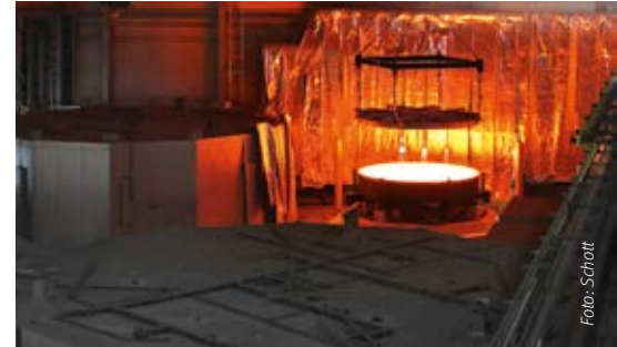
Das Öffnen der Gießform in der Kühlehalle bei Schott.
