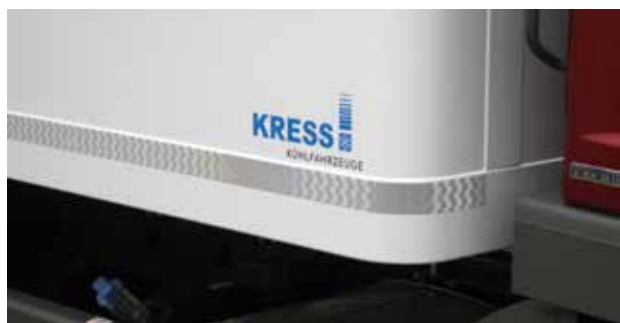
Ein offensichtliches aerodynamisches Detail: Die abgerundeten Kanten der Coolerbox 2.0.
