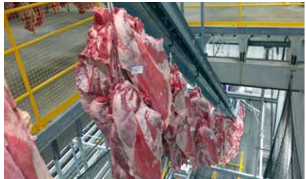
Das Fleisch an Eurohaken wird pro zu beladen LKW in der richtigen Reihenfolge wieder nach unten transportiert.
