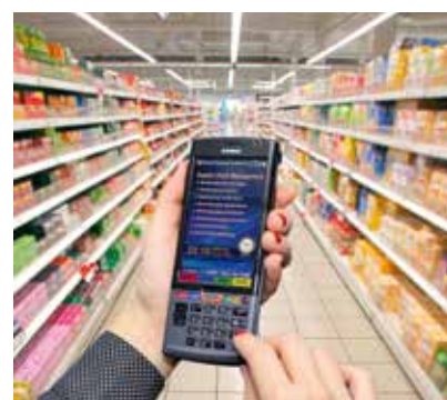
Die ergonomisch angeordneten Scanner- und Eingabetasten des Casio IT-G500 fördern die Einhandbedienung und der abgewinkelte Scannerkopf soll Verkrampfungen und Ermüdungen der Hand verhindern.
