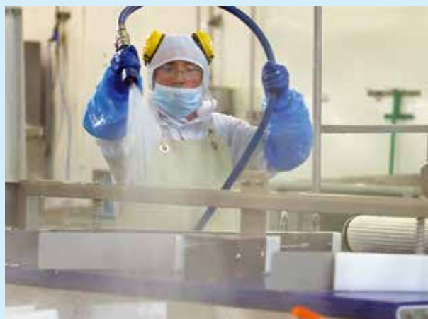
Reinigung einer Förderanlage im Wash-Down-Bereich.
