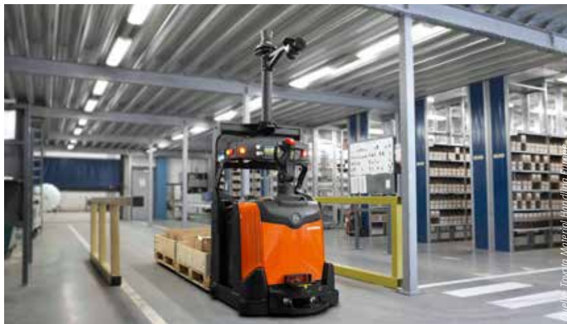
Ein Beispiel für FTS ist das fahrerlose Flurförderzeug mit Autopilot-System von Toyota Material Handling.
