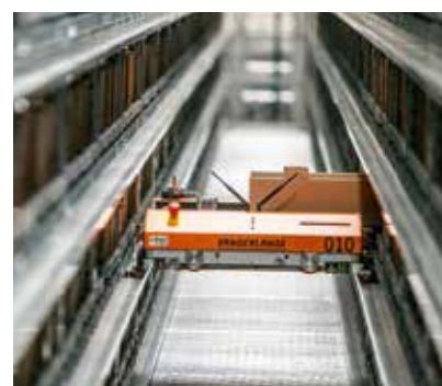
Basis der bei Van Geldern installierten Lösung von Vanderlande: Das Adapto-Shuttle.
