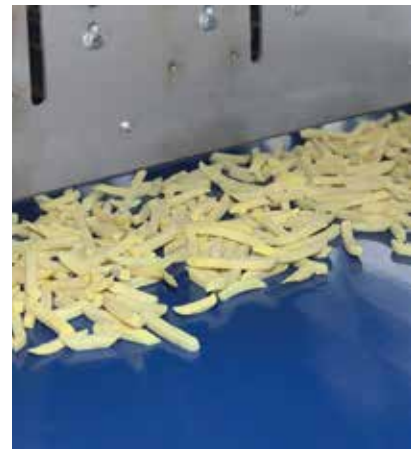
Die aus thermoplastischem Polyurethan (TPU) gefertigten Transportbänder halten einem weiten Temperaturspektrum, zum Beispiel vom Einlaufbereich zur Tiefkühlung bis zum Auslauf von Fritteusen, stand.
