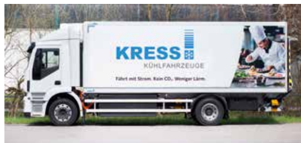
War schon auf der letzten IAA 2016 zu sehen: Ein Coolerbox2.0 Kühlaufbau auf einem vollelektrischen LKW.
