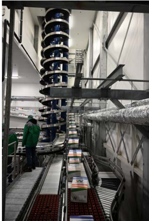
Zur Energieeinsparung werden von Inther bei entsprechenden Kunden nicht Vollpaletten, sondern die einzelnen Kartons in den Gefrierprozess eingespeist.
