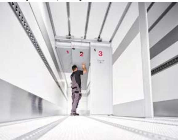
Cool Slide ermöglicht eine einfach zu bedienende Querteilung von Kühlfahrzeugen.
