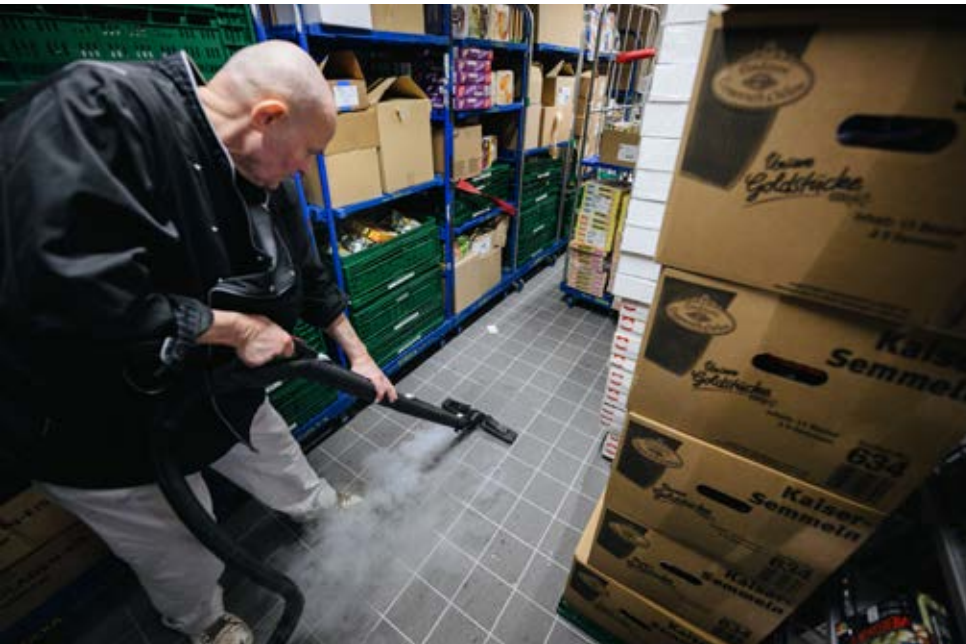
Keine Vereisung im Tiefkühlhaus: Der gelöste Schmutz und das Schmutzwasser werden direkt aufgesaugt, die gereinigten Oberflächen sind sofort wieder trocken.
