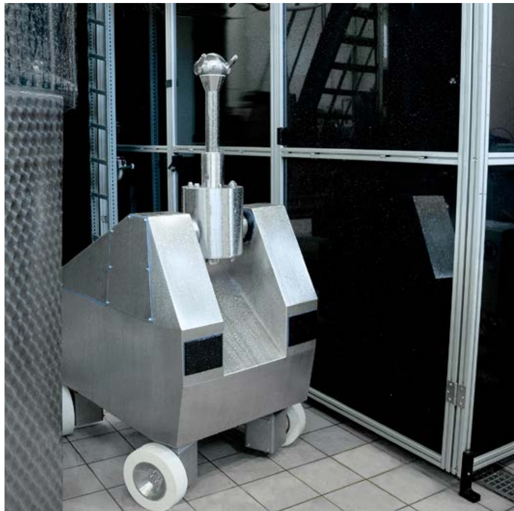
Exo-MCD ist ein intelligenter Reinigungsroboter für die automatisierte und reproduzierbare Reinigung von Anlagen und Produktionsumgebungen – und auf der Iffa erstmals in Deutschland zu sehen.
