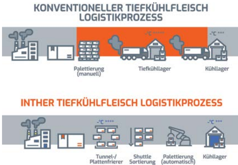
Schematische Darstellung der Logistikprozesse für TK-Fleisch.
